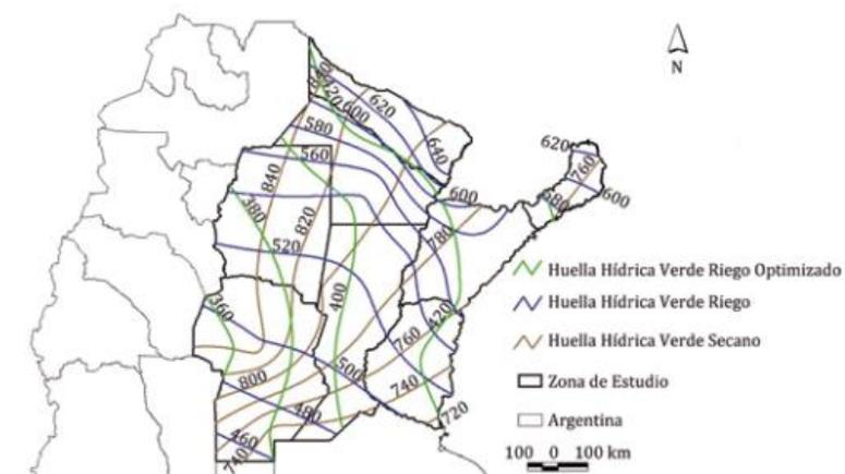
**Figura 2.** Huella hídrica verde del cultivo de maíz ( $L.kg^{-1}$ ) en tres condiciones: secano y fertilidad edáfica al 60%, riego y fertilidad edáfica al 80%, riego y fertilidad edáfica óptimos.
