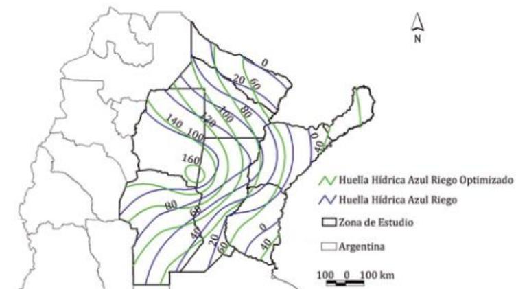
**Figura 3.** Huella hídrica azul del cultivo de maíz ( $L.kg^{-1}$ ) en dos condiciones: riego y fertilidad edáfica al 80%, riego y fertilidad edáfica óptimos
