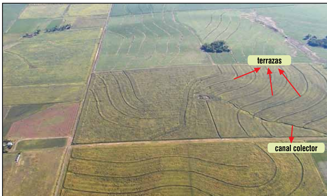
Figura 5. Lotes sistematizados en Entre Ríos, donde se muestra la disposición de terrazas y canal colector (Foto de José Luis Panigatti).
