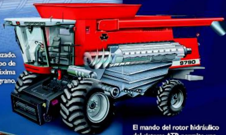
El mando del rotor hidráulico del sistema ATR permite una rotación constante del rotor independientemente de las vueltas del motor, logrando velocidad constante, reducción de pérdidas y alta productividad en condiciones extremas.
